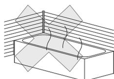
透湿防水シート、またはアスファルトフェルト 430 以上（通気構法以外）を使用してください。
