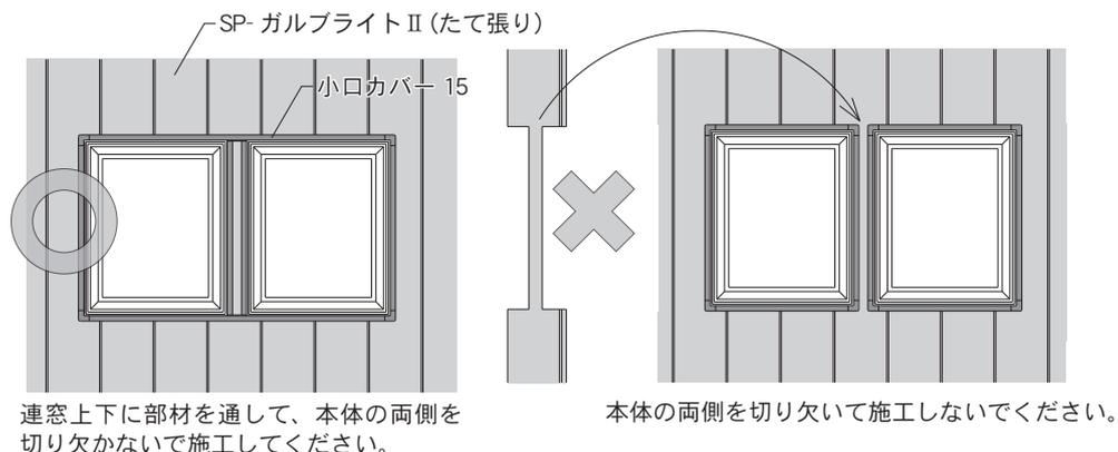
連窓上下に部材を通して、本体の両側を切り欠かないで施工してください。
